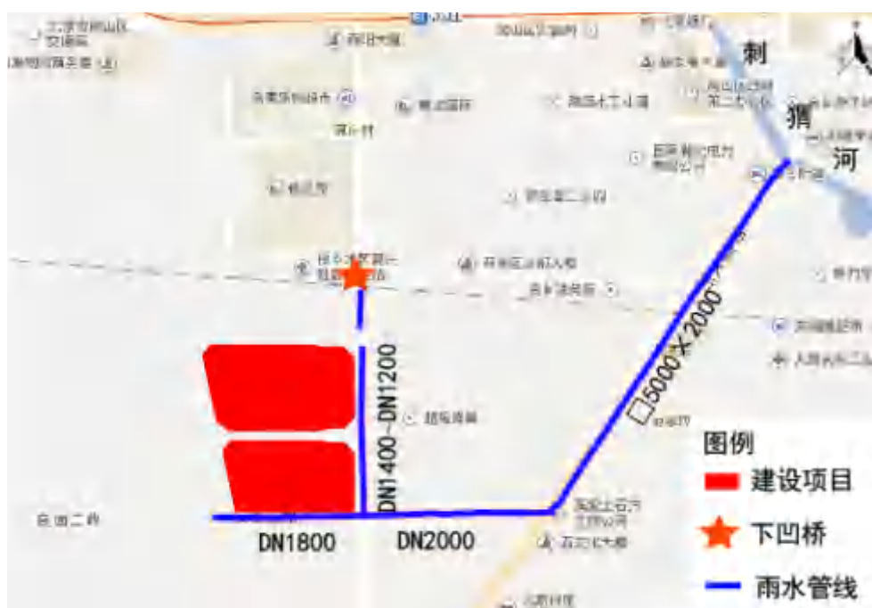
图 3.2-15 项目区雨水排出路由布置图
