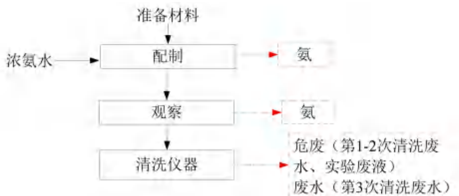
图 2-18 分子运动现象实验（2）工艺流程及产污环节图
