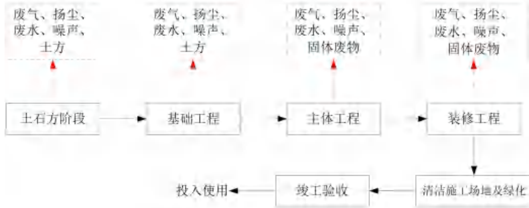
图 2-5 施工期工艺流程及产污环节示意图
