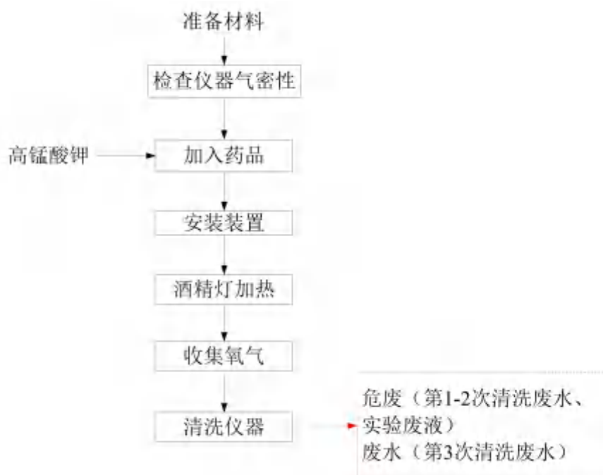
图 2-6 氧气实验室制取工艺流程及产污环节图
