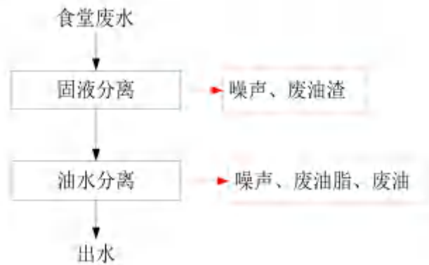
图 2-37 隔油处理提升一体化设备工艺流程及产污环节图
