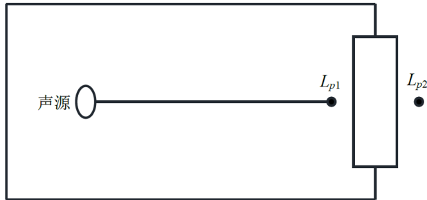
图4-1 室内声源等效为室外声源图例
