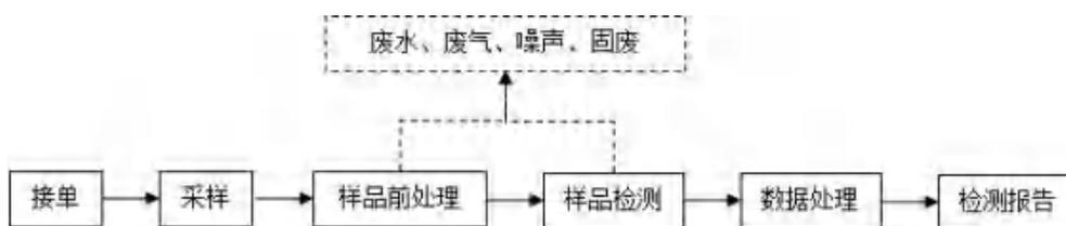
图 2-7 理化检测流程和产污环节图
