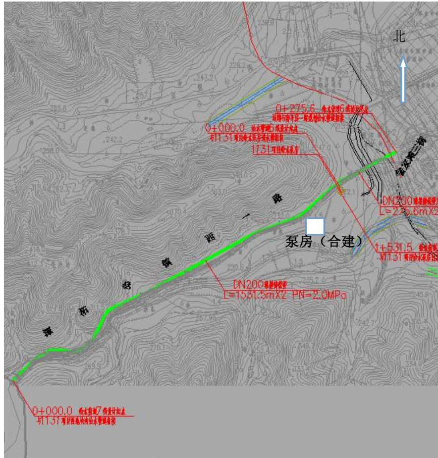
实际建设供水管道平面布置图
