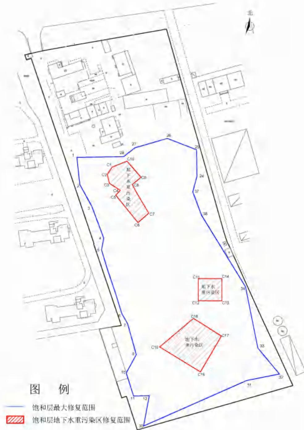
图 1-5 饱和层地下水重污染区与轻污染区平面分布图
