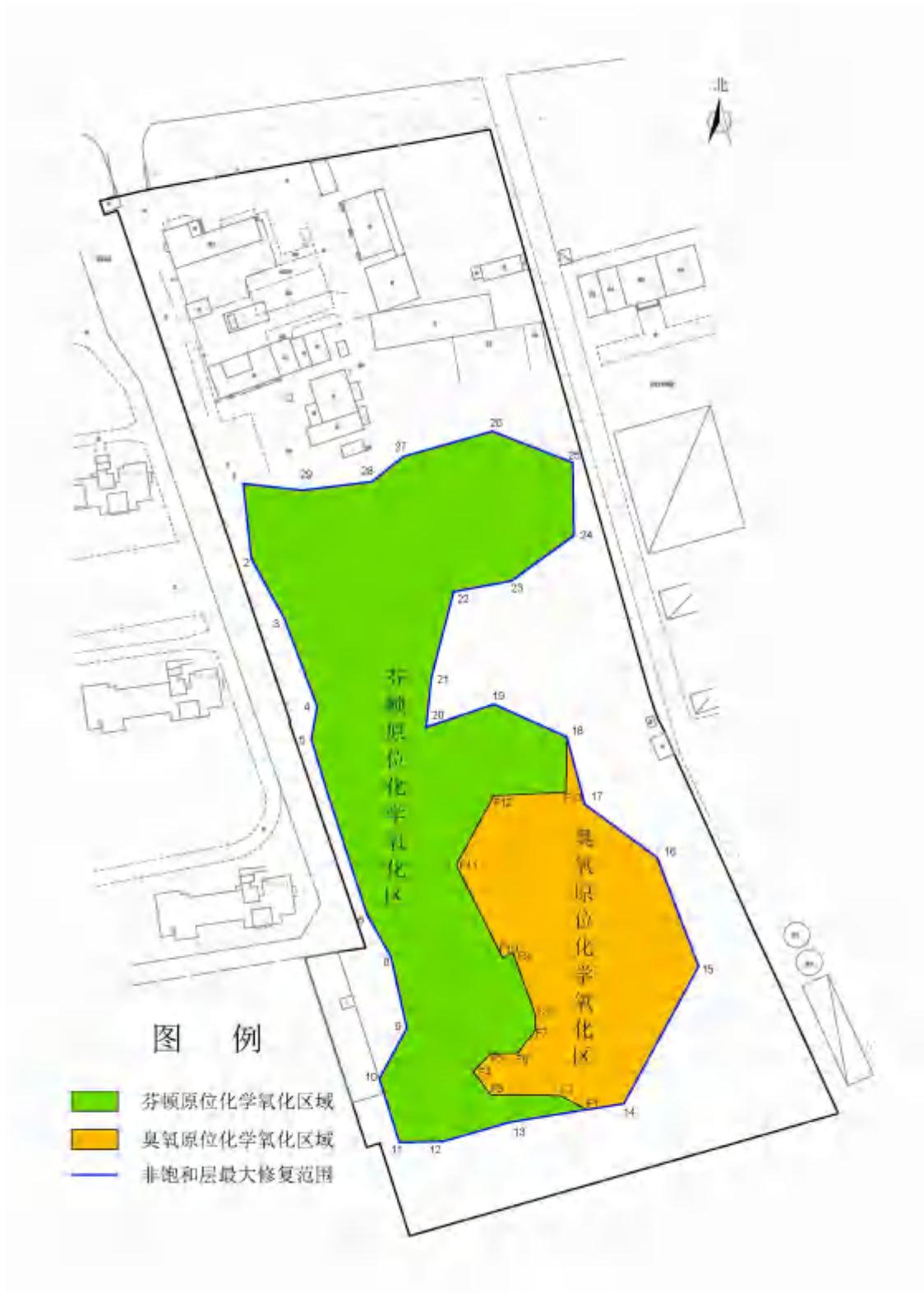
图 5-2 非饱和层采用修复技术平面分布图
