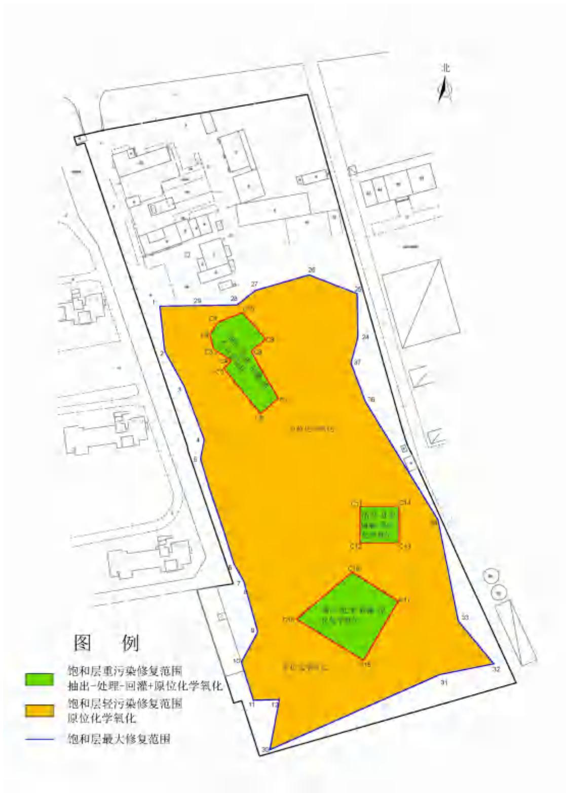
图5-3 饱和层采用修复技术平面分布图
