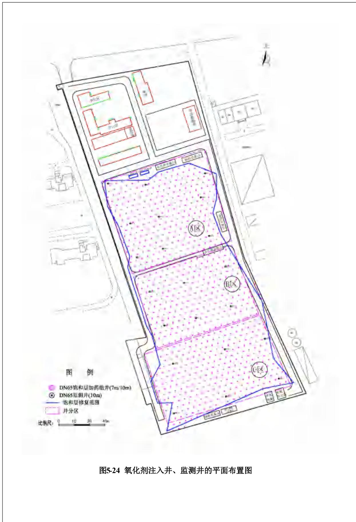
图5-24 氧化剂注入井、监测井的平面布置图
