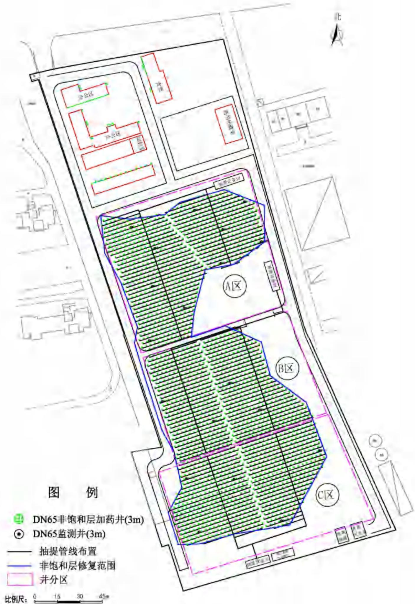
图5-12 抽提管线的平面分布示意图
